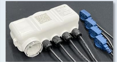
Fin fan vibration measurement
